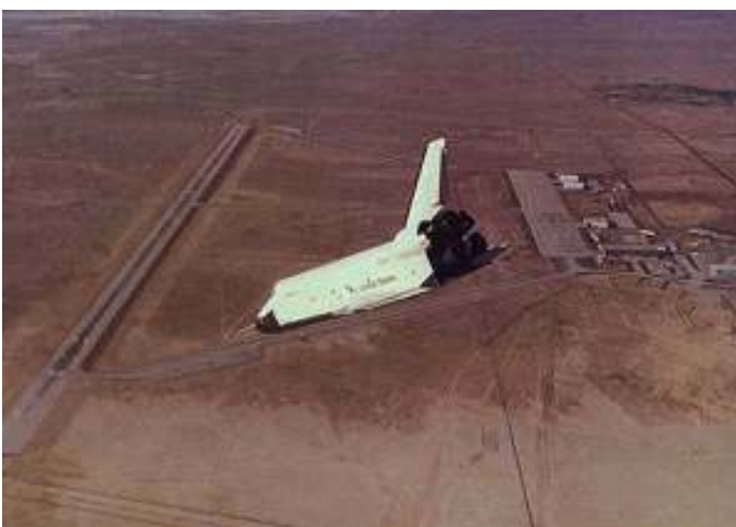
figure 31: Cette image nous donne une bonne représentation de l'angle d'attaque que la navette adopte en phase d'approche pour l'atterrissage.
