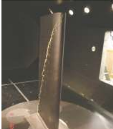
figure 15: Voici un profil d'aile dans la 3 ème plus grande soufflerie de Suisse à l'ETHZ. Nous avons collé des bouts de fil de laine jaune en diagonale du profil d'aile pour observer l'écoulement de l'air en changeant l'angle d'attaque et la vitesse du flux d'air produit par la turbine (qui va jusqu'à 220 km/h).
